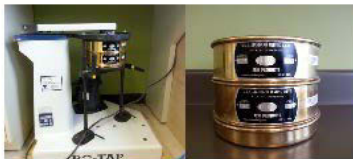
Figure 2.3 : Tamiseur M.S.Tyler et tamis (710 \mu\text{m} ; 150 \mu\text{m} ).
