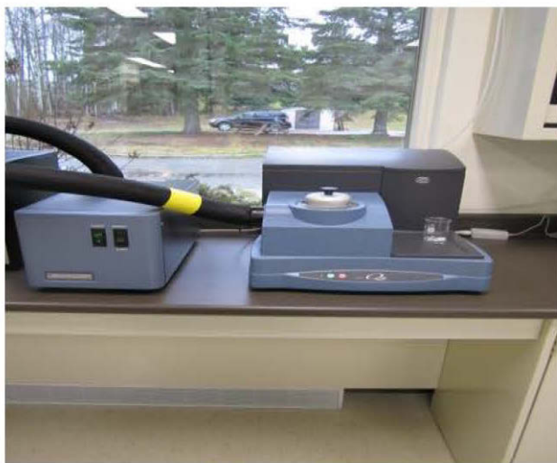
Figure 2.6: Appareil calorimétrique différentiel à balayage du laboratoire de biomatériaux de l'UQAT.
