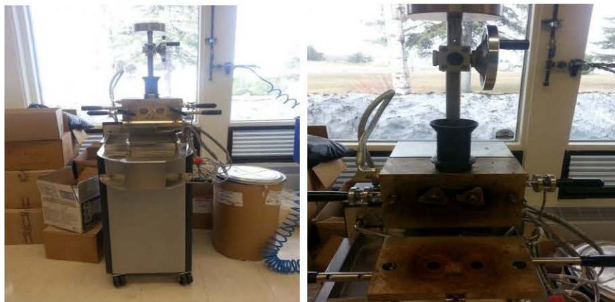
Figure 2.9: Rhéomètre à couple du laboratoire de biomatériaux de l'UQAT.
