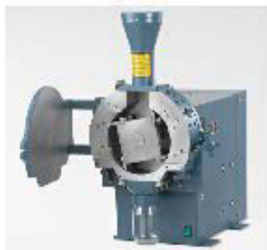
Figure 2.2: Broyeur à couteaux rotatifs (Thomas Willey, modèle 4).
