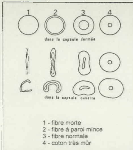
Figure A-13 : Coupe schématique de fibres immatures à très mûres ; dessèchement et aplatissement des fibres après ouverture de la capsule (d'après Roehrich, 1947b et Jacquemart, 1953).
