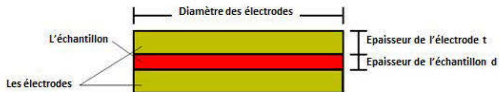
Figure 2.8 : Représentation de la configuration des deux électrodes (adapté de http://www.novocontrol.de )
