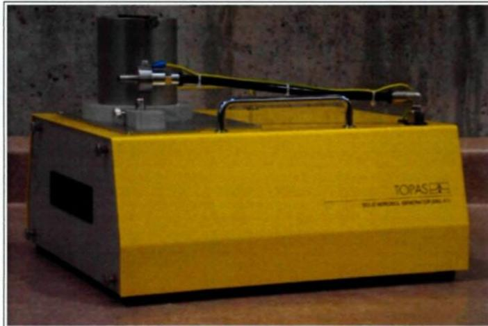
Figure IV.6: Générateur d'aérosols solides à faible débit SAG 410L.
