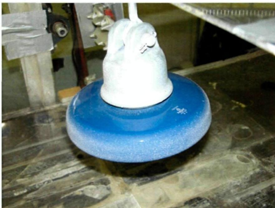
Figure V.6: Photo de l'isolateur après la période d'accumulation – Soufflerie réfrigérée
