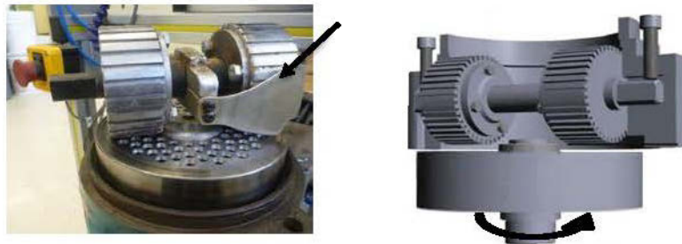
Figure 2.6 : Aperçu de l'équipage mobile de la chambre de granulation et des déflecteurs
