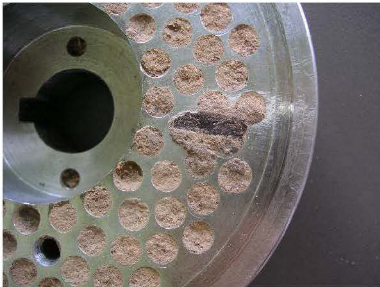
Figure A.1 : aperçu de la couche fusionnée sur la matrice
