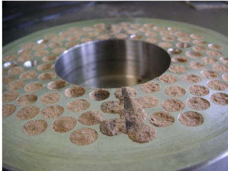
Figure A.1 : aperçu de la couche fusionnée sur la matrice
