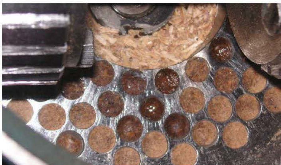
Figure 4.14 : Suintement de liquide à la surface de certaines granules à l'entrée des canaux de compression, dans les 15 secondes et après aspiration du mélange en sciure.
