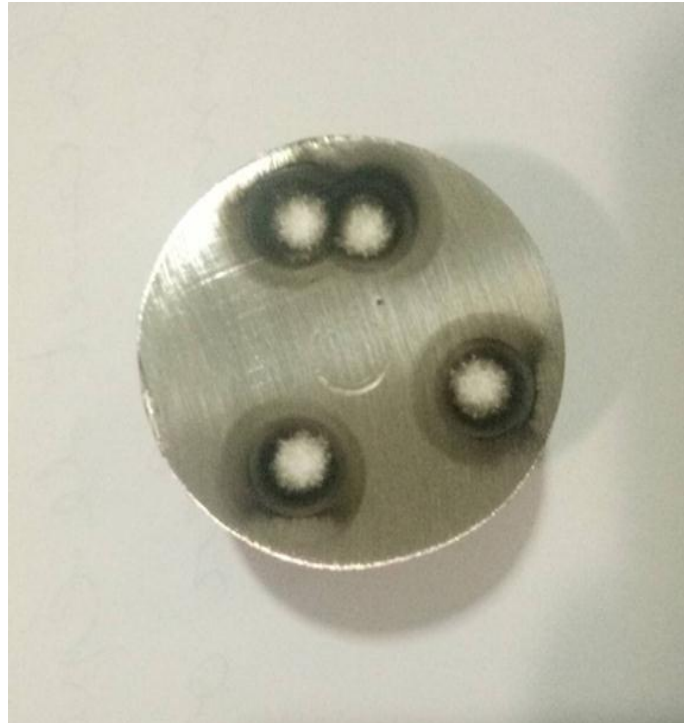
Figure III.16 - Traces des étincelles sur l'échantillon.
