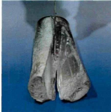
Figure 2.5 : Coup d'un lopin d'aluminium semi-solide [11].
