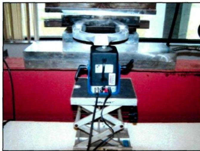
Figure 4.17 : Expérience des fréquences par le pot vibrant.
