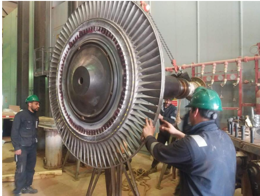
FigureI.16 : La roue BP (turbine MS5002B)
