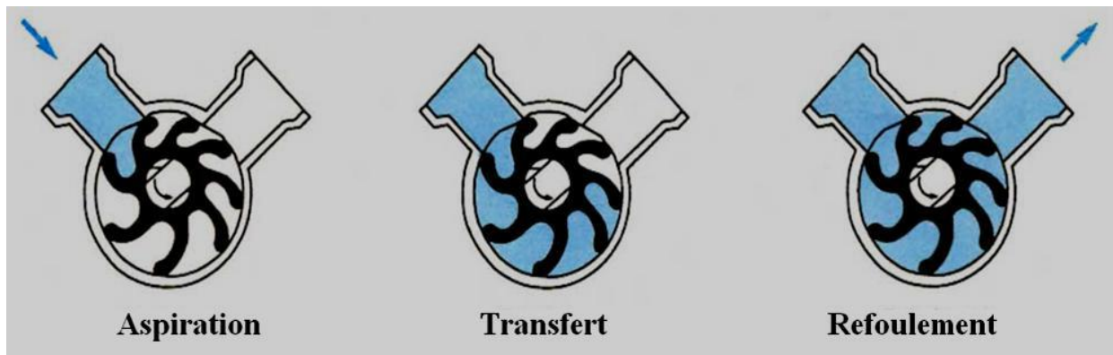
Figure (1-5) : Pompes à palettes flexibles [4]
