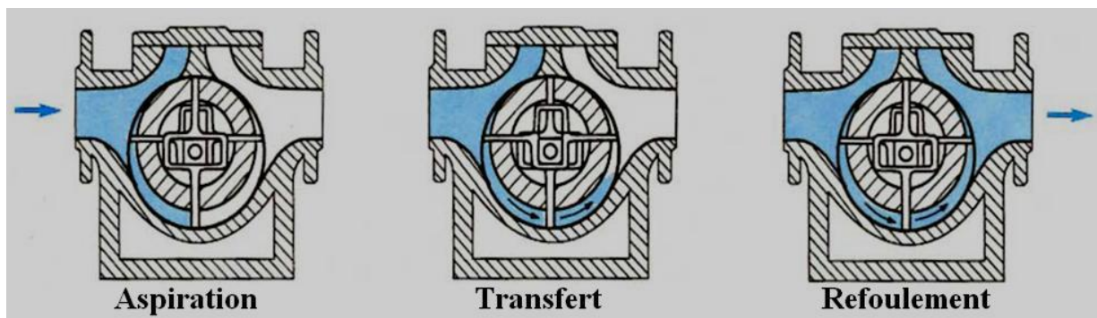
Figure (1.6) : Pompes à palettes guidées [4]
