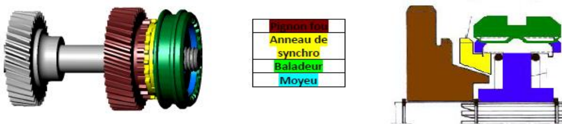
Figure II.14 : Composition du synchroniseur
