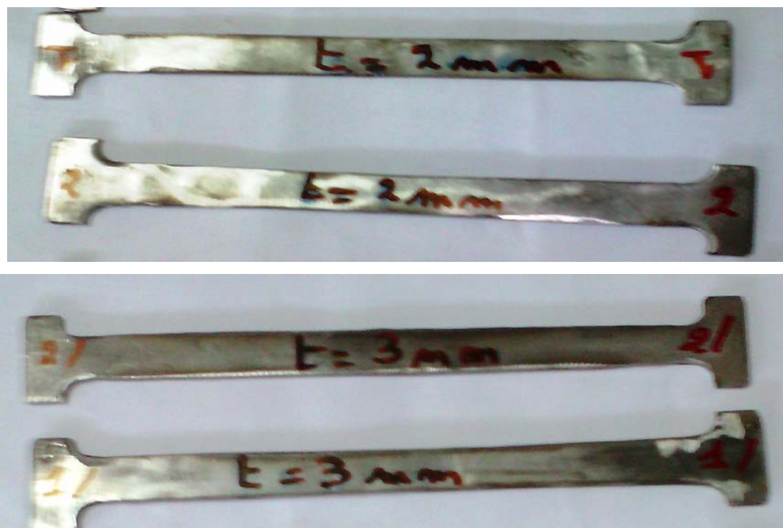
Figure 3.2b : Eprouvettes de traction réalisées en 304 L
