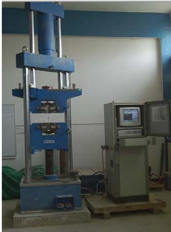
Figure 3.1: Machine 600 KN pour d'essai de traction (labo génie civile fac technologie)
