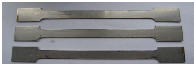
Figure 3.3 : éprouvette pour l'essai de traction en 304 L.
