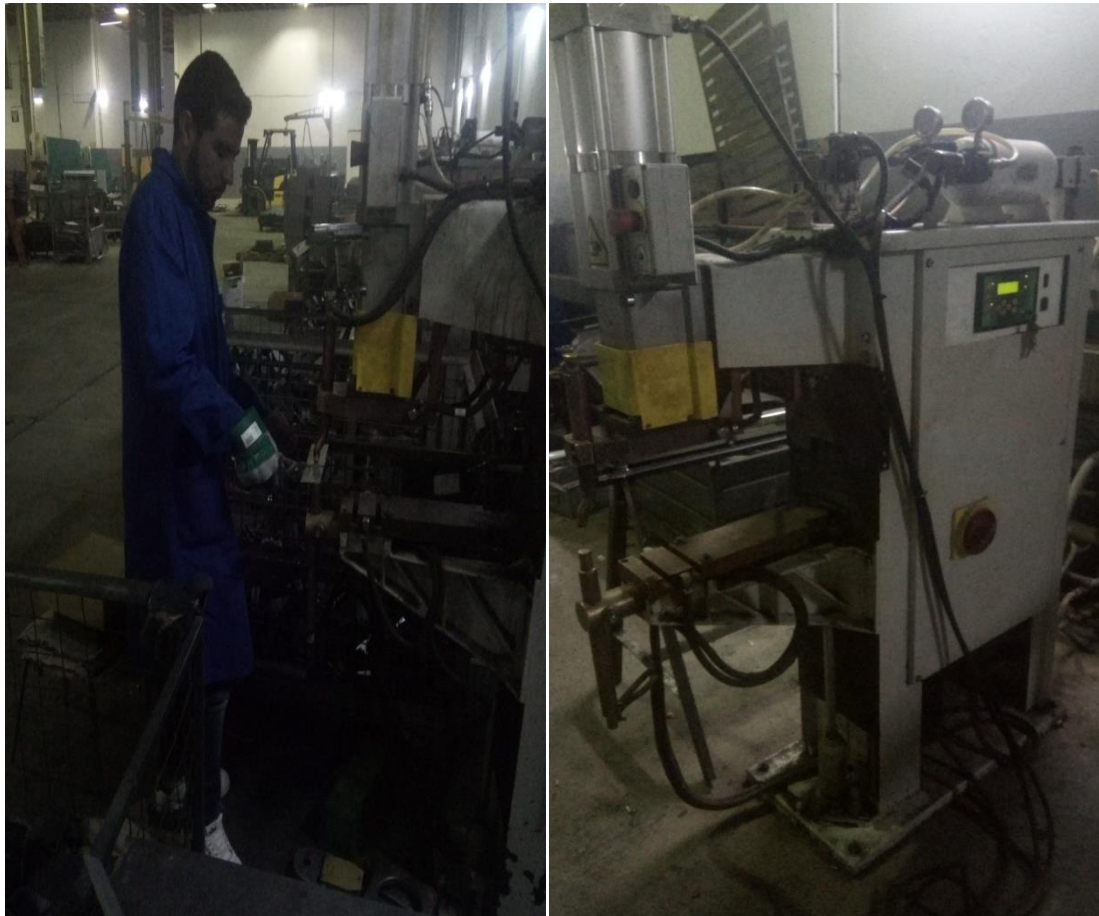
Figure 3.10 : la machine de soudage par points TECNA CE 800XN
