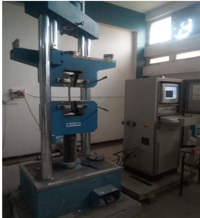
Figure 3.1 : Machine 600 KN pour d'essai de traction
