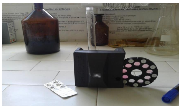
Figure 10: comparateur de chlore en lumière du jour
