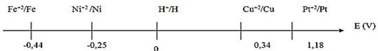
Figure 3 : Potentiel standard de réaction d'électrode par rapport à l'électrode normale à hydrogène
