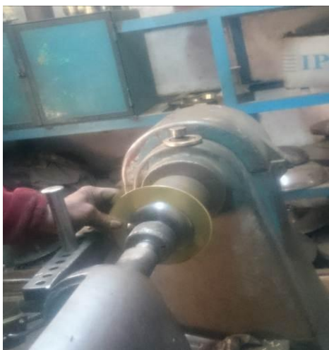
Image 3 : procédé de déformation d'une pièce.
