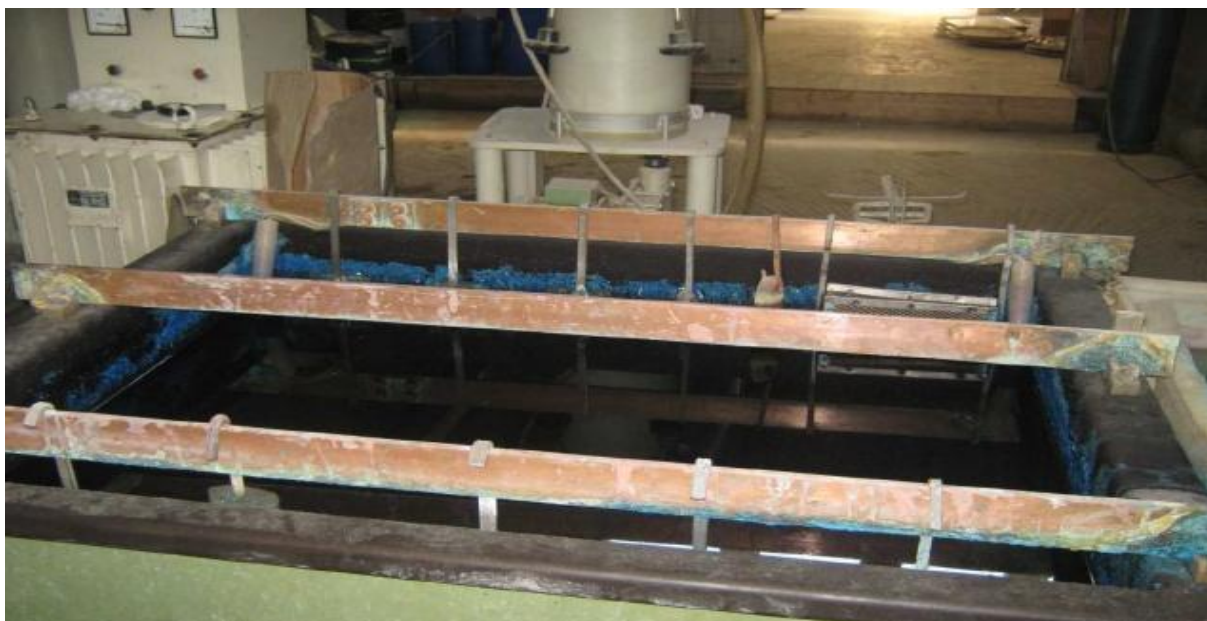
Figure 17 : Bain de cuivrage acide
