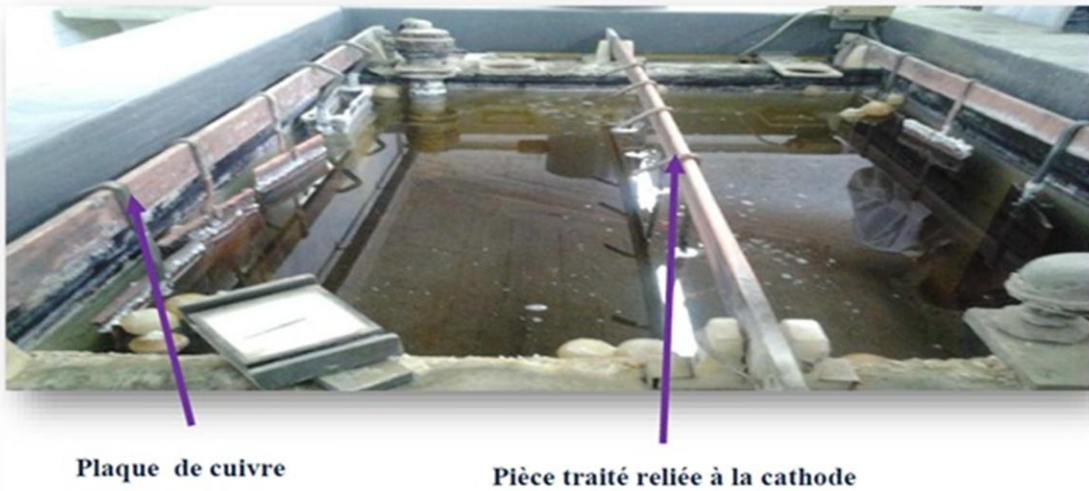
Figure 16 : Bain de cuivrage alcalin
