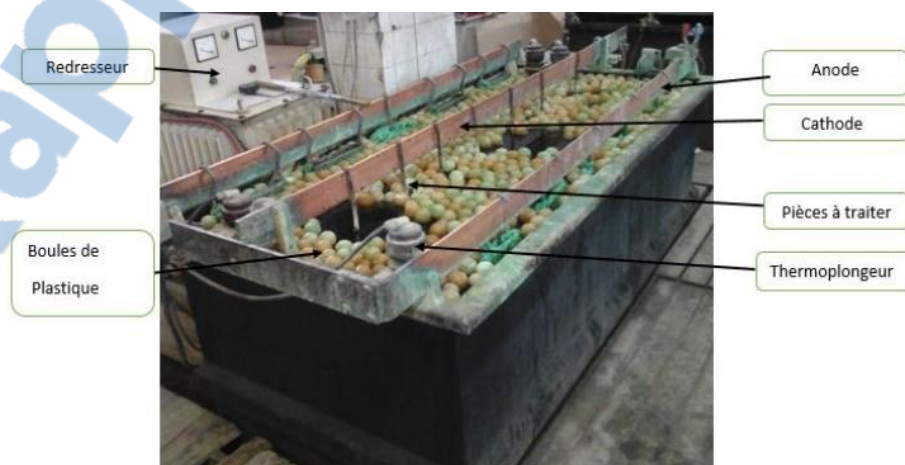
Figure 18 : Bain de nickelage
