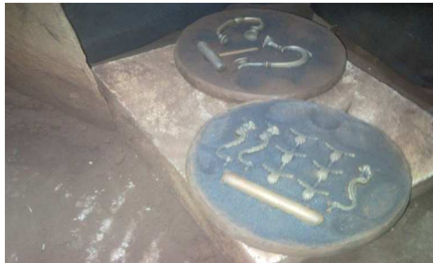
Photo9 : Les moules d'un sable particulier
