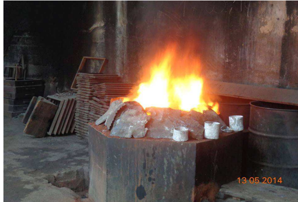
Photo 8 : Four de fendage des chutes du laiton
