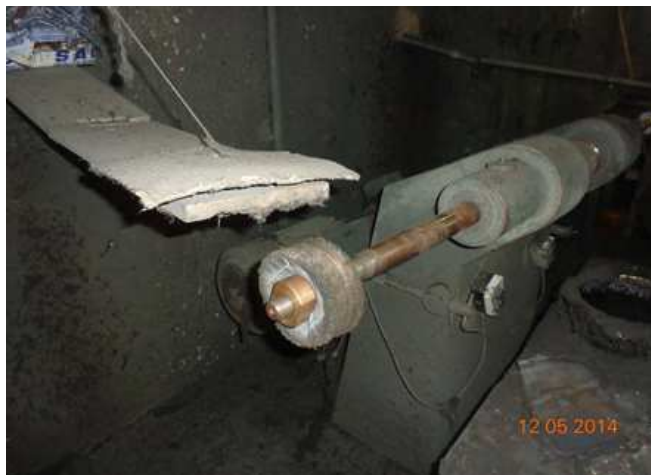
Photo 14 : Machine de polissage équipé de papier abrasif
