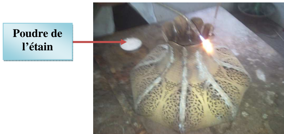
Photo 12 : Une soudure réalisée avec un chalumeau et l'étain
