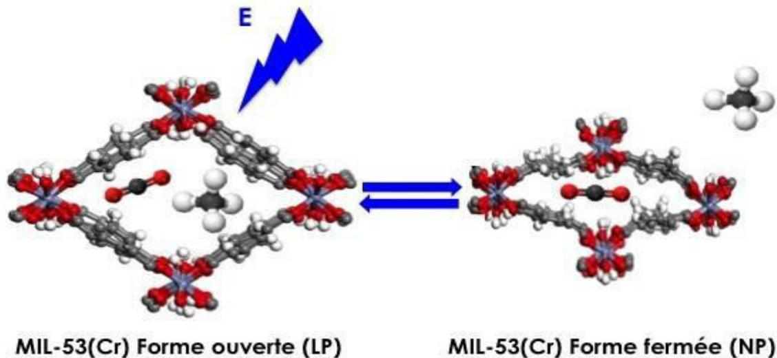
**Figure I.5 :** Illustration de la transition de phase électriquement stimulable dans la MIL-53(Cr) en présence de CO<sub>2</sub> et de CH<sub>4</sub>. Les formes ouverte (LP=Large pore) et fermée (Narrow pore) sont représentées [65].
