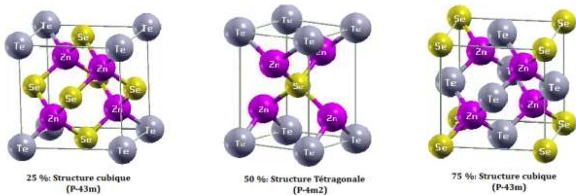
Figure III.B.13. Structures cristallines des composés ternaires obtenus par substitution des atomes de S par ceux de Se.
