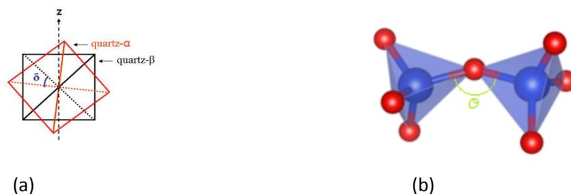
**Figure 1. 4 :** (a) Angle  $\delta$  de rotation des tétraèdres, (b) Angle  $\theta$  de pont inter-tétraèdres.
