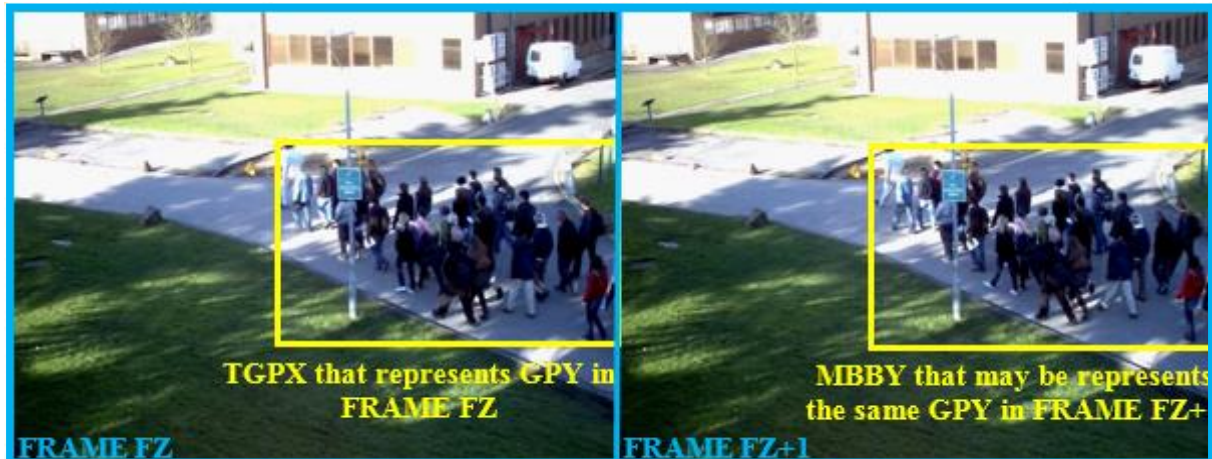
Figure 21. Illustration d'une règle SWRL pour tester si le bounding box majeur détecté dans l'image FZ+1 représente le même groupe GPY détecté dans l'image FZ.
