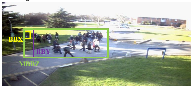
Figure 20. Illustration d'une règle SWRL pour le groupement de deux bounding boxes en un seul majeur.
