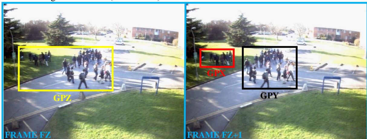
Figure 22. Illustration d'une règle SWRL pour le test d'un évènement de division du groupe GPZ.
