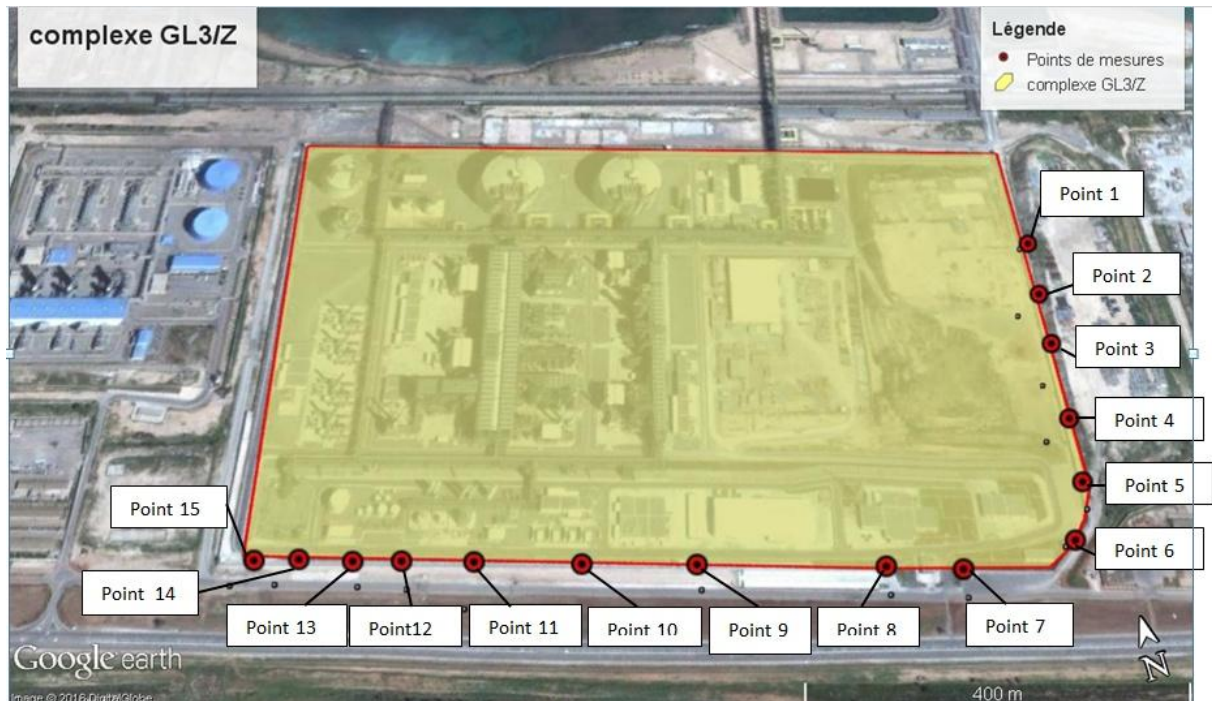
Figure II.4 : positions de mesurage de bruit en limites batterie pour le complexe GNL3/Z.
