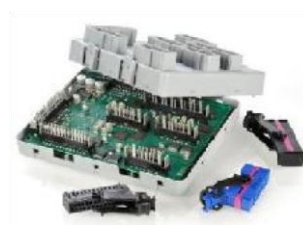
Les boîtes de jonction à puce Figure 3 : Types d'EPMS
