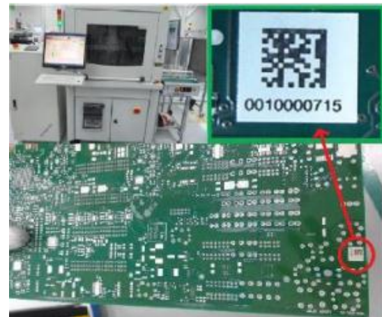
Figure 12: Machine Laser et panel après scan
