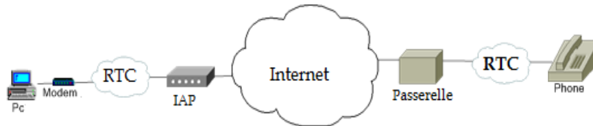
Figure2.2: La voix sur IP entre un ordinateur et un téléphone
