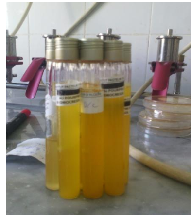
Figure 7 : changement de couleur indiquant la présence des coliformes fécaux(le 03/03/2016)
