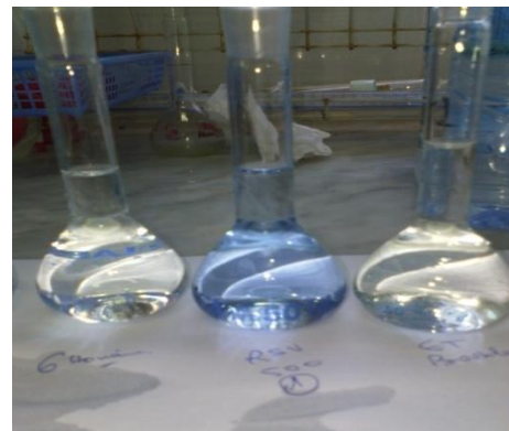
Figure 4 : changement de couleur indiquant la présence des phosphates (01/03/2016)
