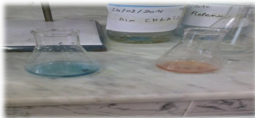
Figure 1: Changement de couleur indiquant le virage du pH (le 25/02/2016)
