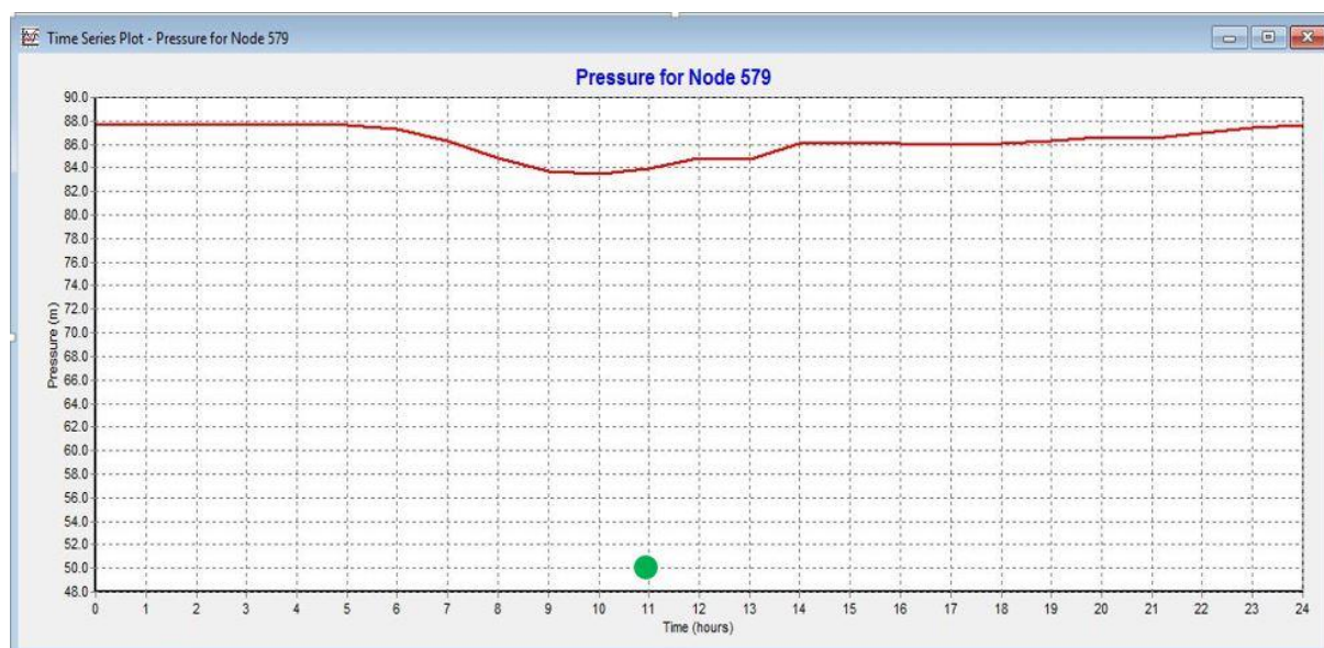
Figure V. 15 : Graphique comparatif entre la pression mesurée et la pression simulée au Point 7 (Nœud 579)
