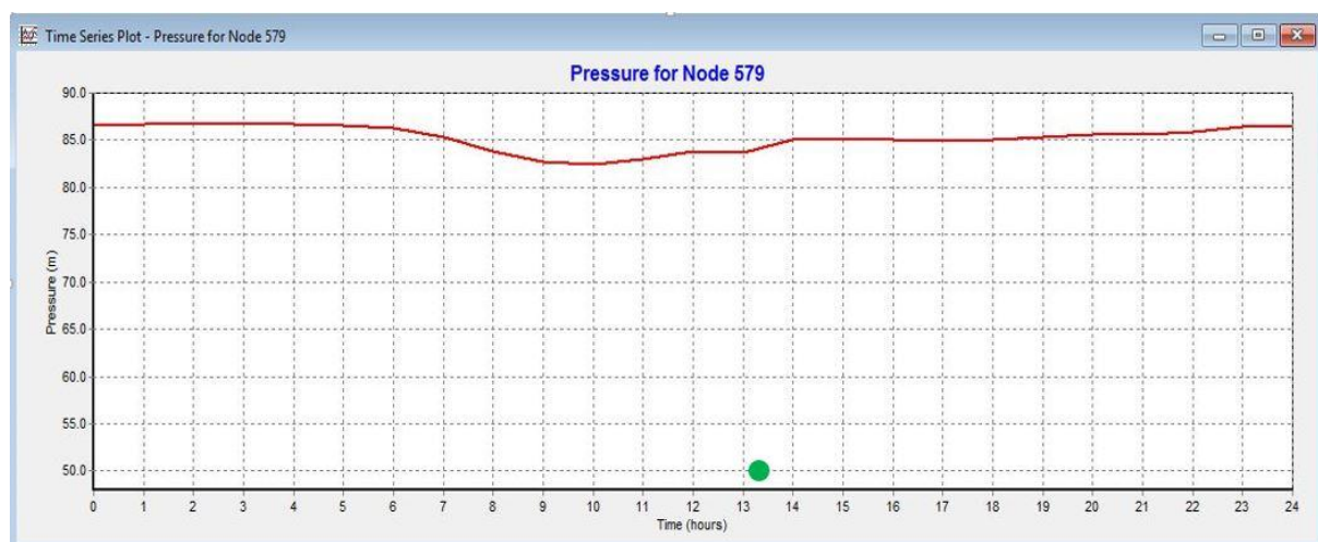
Figure V. 18 : Graphique comparatif entre la pression mesurée et la pression simulée au Point12
