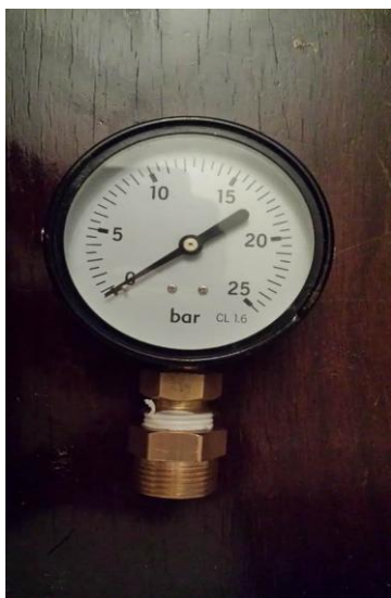
Figure V. 7 : Manomètre à tube de Bourdon
