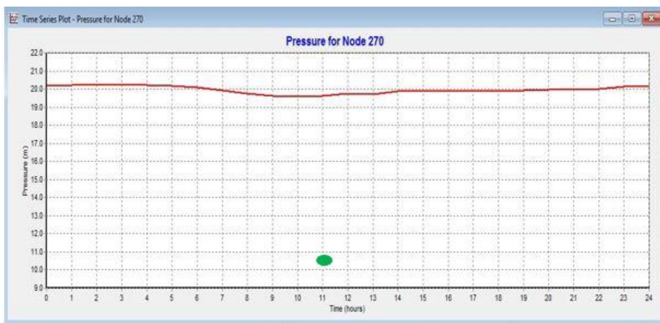
Figure V. 11 : Graphique comparatif entre la pression mesure et la pression simulée au point 1 (nœud 270)
