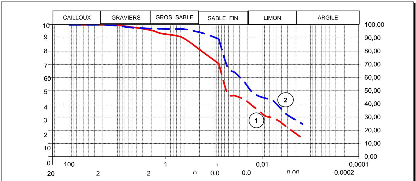
Figure III.17 : courbe granulométrique résultante pour les fouilles Ouchba (1) et Ain Fezza (2)
