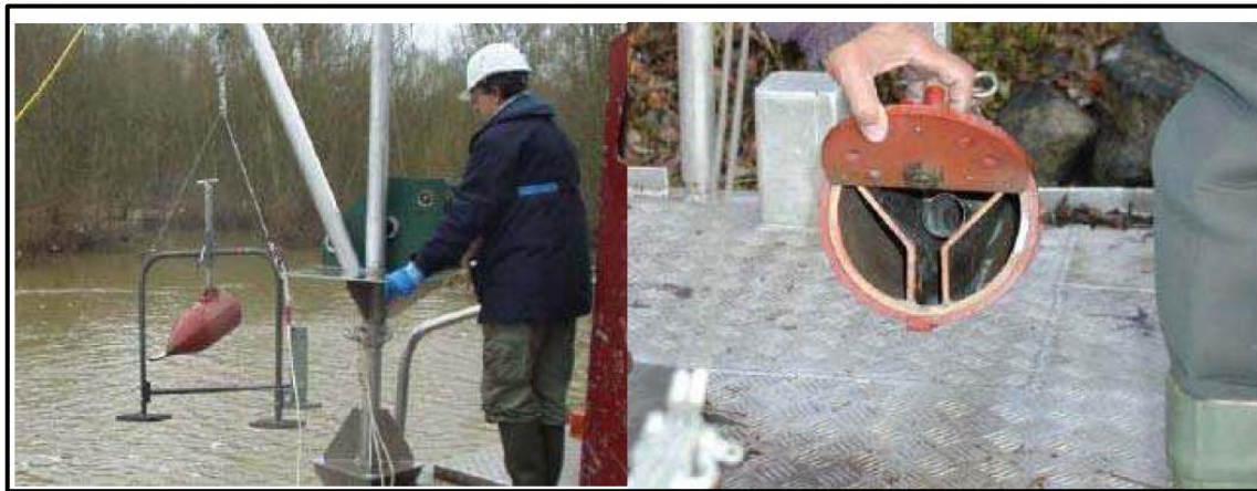
Photo.I.3. Appareil de mesure de la charge en suspension (Mussy2002).
