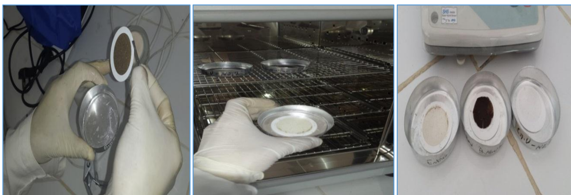
Figure IV.15 : Principaux étapes d'analyses de MES filtration à vide séchage et pesé (respectivement de gauche à droite).
