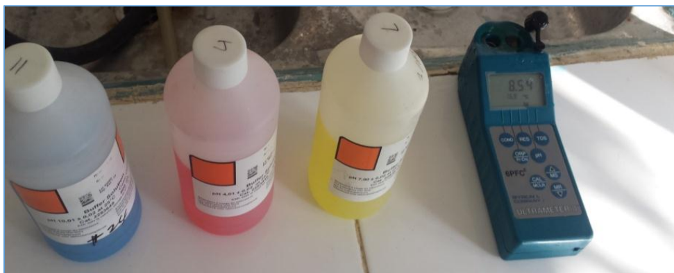
Figure IV.18 : Calibrage de l'appareil avec solution pH.
