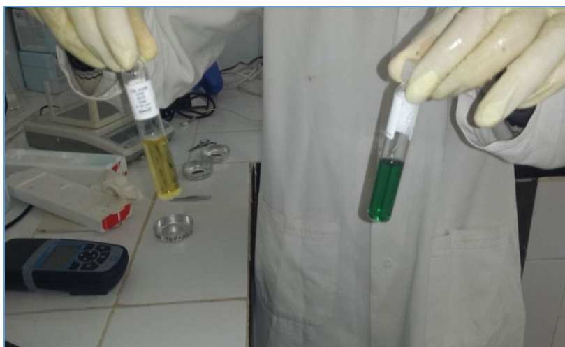
Figure IV.12: Photo qui indique la présence du phosphore dans l'échantillon.
