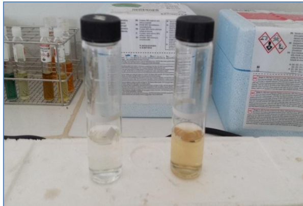
Figure IV.10 : Photo de la cellule d'échantillon qui indique la présence de nitrate.
