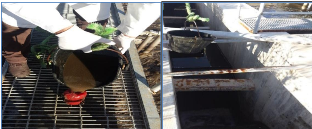
Figure IV.1 : Prélèvement au bassin d'aération à gauche, à la sortie au niveau de bassin de désinfection sur la photo située à droite.
