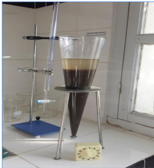
Figure IV.16 : Photo qui montre le teste de décantation avec le Cône Imhof et minuterie.
