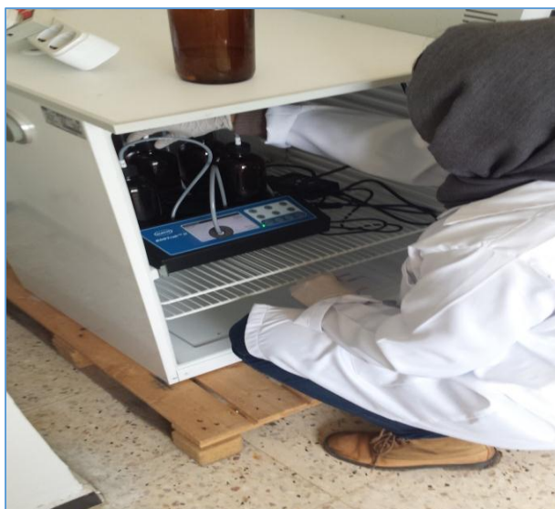
Figure IV.14 : L'ensemble des bouteilles sur le châssis dans l'incubateur.
