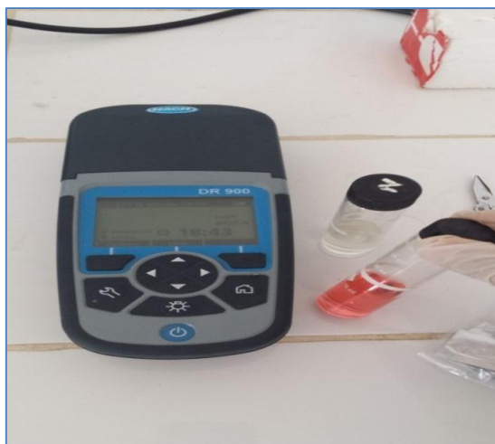
Figure IV.11 : Photo indiquant de la présence de nitrite dans l'échantillon.
