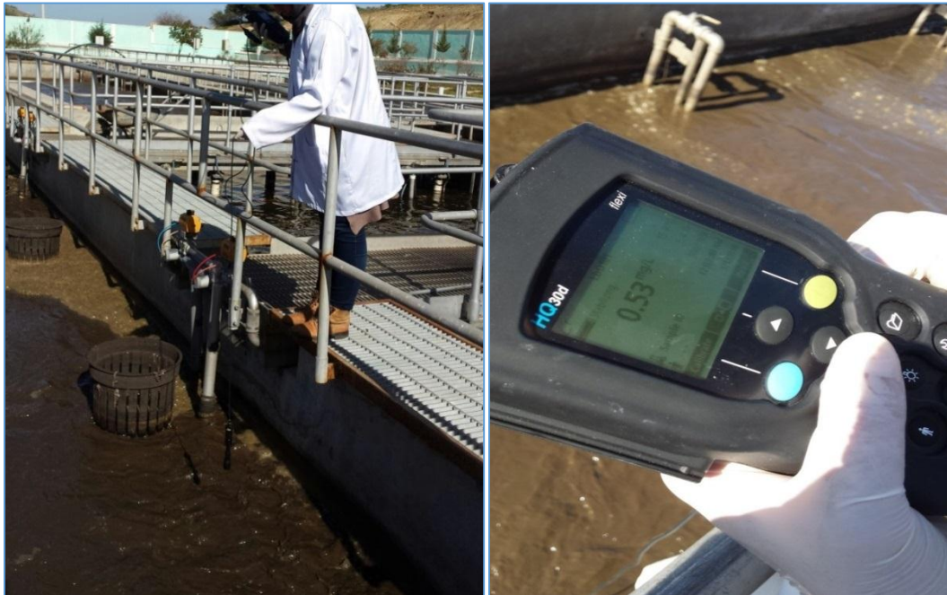
Figure IV.19 : Mesure d'oxygène dissous dans le bassin d'aération avec l'appareil multimètre.
