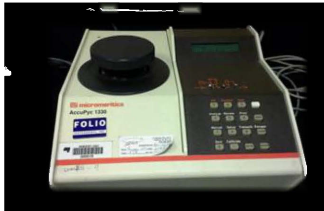
Figure 3-2 : Pycnomètre à hélium ( photo prise au laboratoire de l'unité de recherche et de services en technologie minérale (URSTM) de l'IRME-UQAT )
