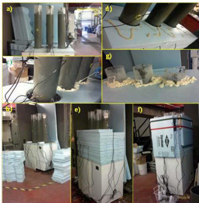
Figure 3-12 : Montage de colonnes pour essais dans le congélateur
