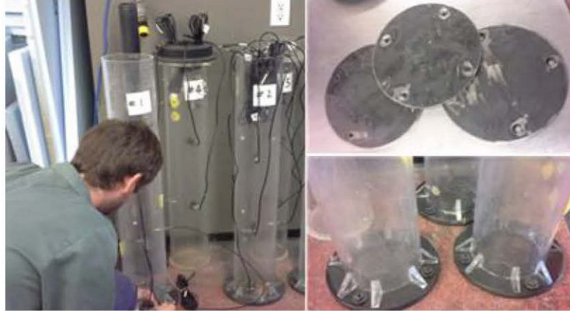
Figure 3-11 : Colonnes avec bases en acier et instrumentées avec sondes de température
