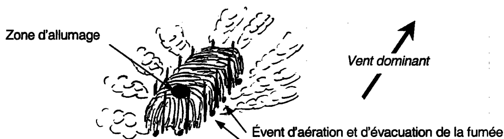
Figure 14 : Meule en cours de carbonisation
