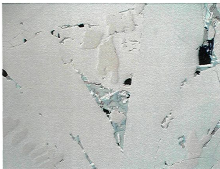
Figure 4.6 : Cliché d'un échantillon de ferrosilicostromium standard à 200X
