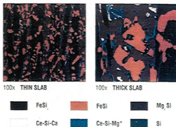
Figure 2.4 : Phases présentes dans le ferrosilicomagnésium selon deux coulées [15]
