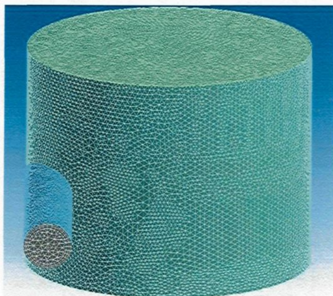
Figure 4.7 : Maillage du puits d'alimentation de Gove
