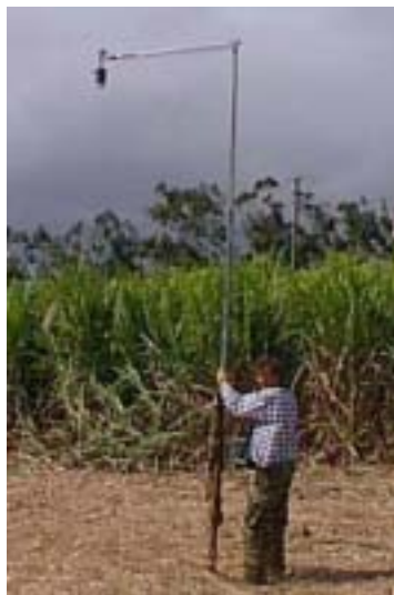
Photographie 2. Prise de mesures au radiomètre Cimel CE-310 sur du paillis.
