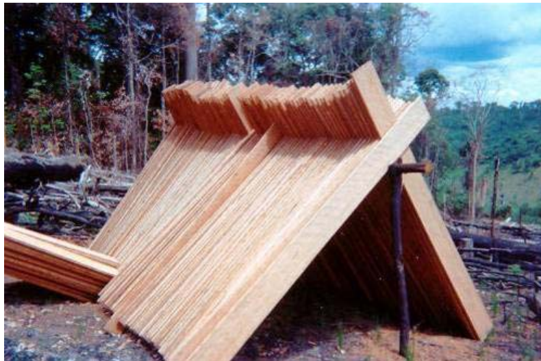
Planches débitées à la tronçonneuse pour la construction d'un séchoir (photo : T. Bonaudo)
