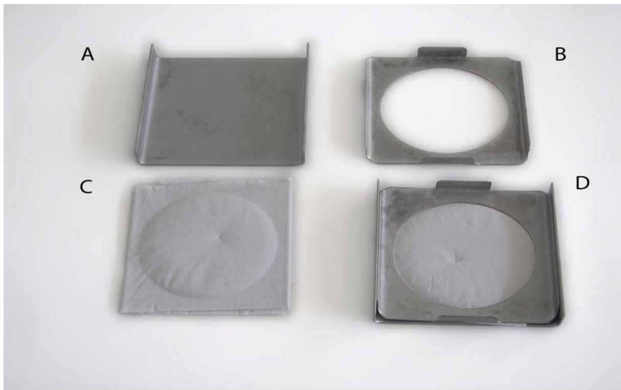
Figure 2 : Porte-échantillon en acier inoxydable utilisé pour les essais : base pleine (A), système de fixation (B), échantillon à traiter (C), porte-échantillon complet (D).
