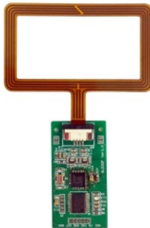
Figure 13 : Lecteur RFID 13.56 mHZ avec antenne, environ 30CHF
