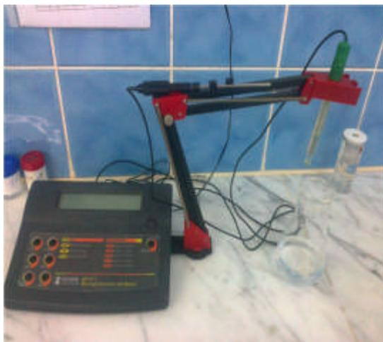
**Photo IV.4 : Thermomètre et pH-mètre de la station de Sekkak**
