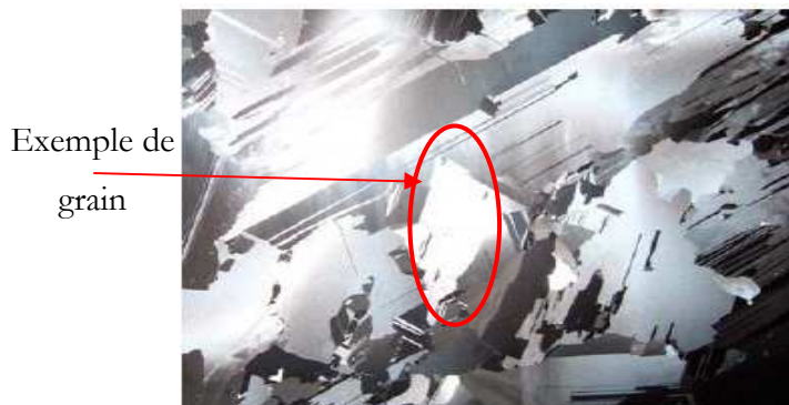
Figure I.15: Photo d'un substrat de silicium multicristallin (échelle : 10×10 cm 2 ).
