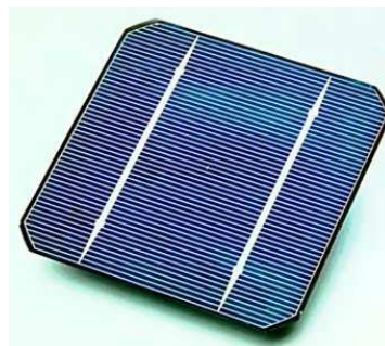
Figure I.16 : Cellule solaire au silicium monocristallin [5]
