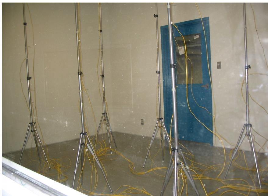
**Figure II.4 Emplacement des thermocouples dans la pièce modèle.**
