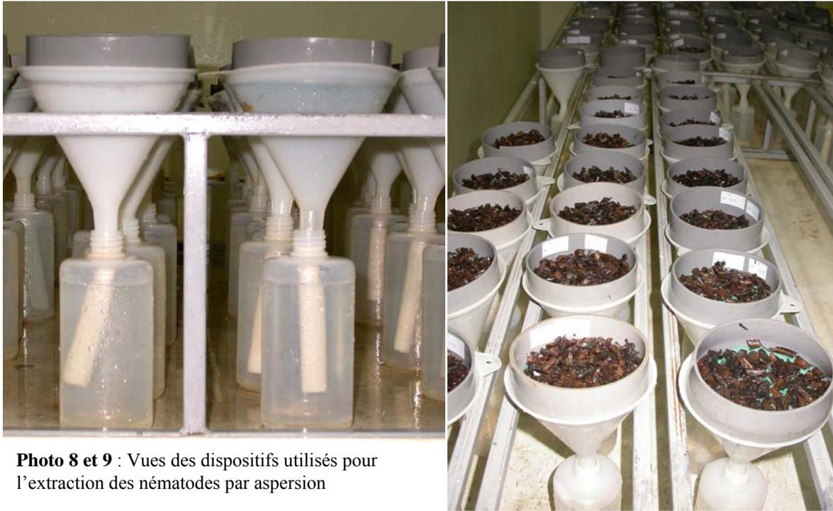
**Photo 8 et 9** : Vues des dispositifs utilisés pour l'extraction des nématodes par aspersion
