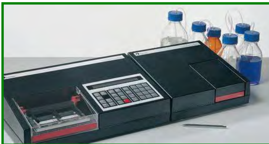
Photo du PhastSystem sur lequel sont effectuées les électrophorèses
