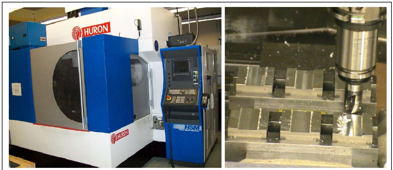
Figure 2.1 Usinage sur centre d'usinage 3 axes HURON K2X10.
