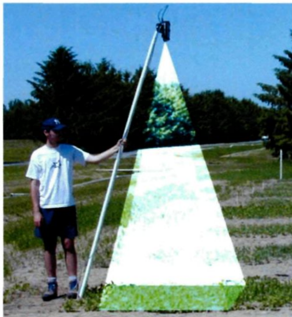
Figure 4: Prise de mesures de réflectance à l'aide d'un spectroradiomètre
