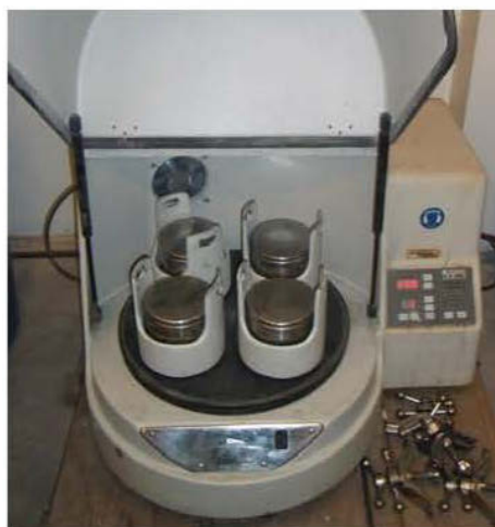
Figure 4.4 Pulvérisette de laboratoire pour la préparation des échantillons pour les analyses physico-chimiques et DRX
