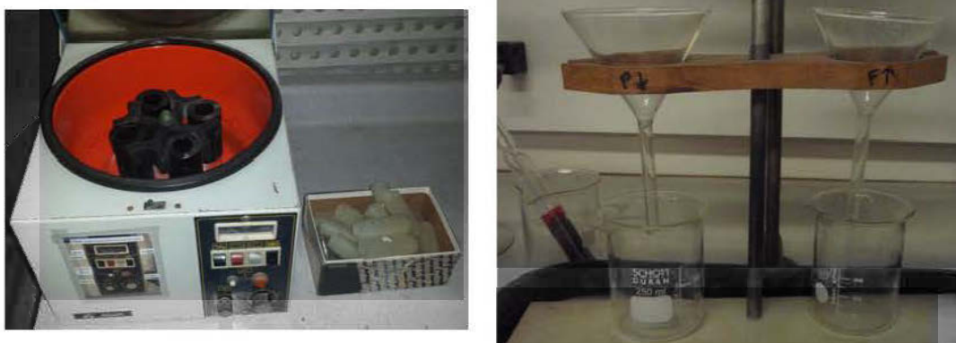
Figure 4.6 Dispositif de séparation en liqueur dense par centrifugation. À gauche, la centrifugeuse, à droite, le dispositif de filtration.
