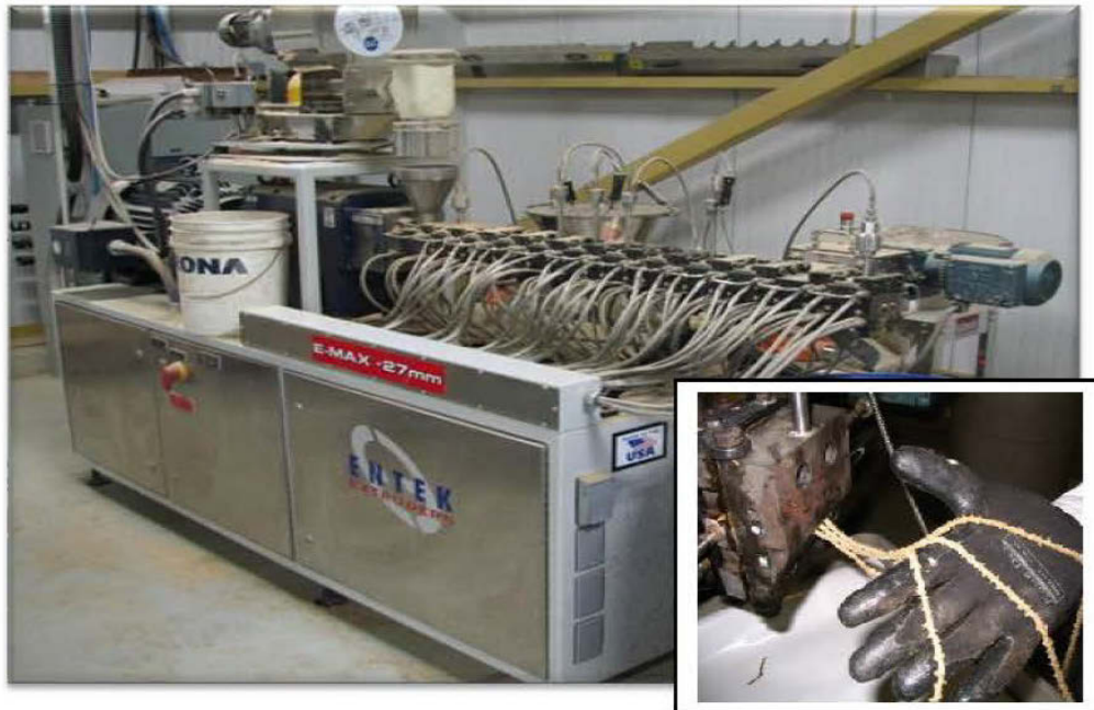
Figure 2.4 : Extrudeuse à double-vis, Entek Technologies, utilisées pour les essais à l'échelle, laboratoire pilote.
