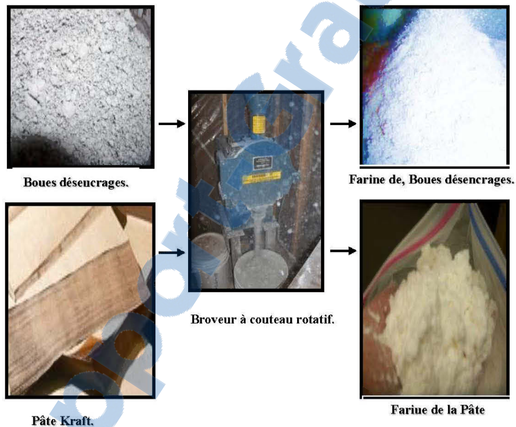
Figure 2.1 : Préparations de la farine de bois pour la fabrication des composites au laboratoire
