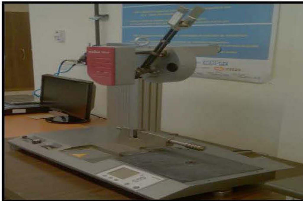
Figure 2.5 : Dispositif d'essai de choc IZOD utilisé pour la mesure de la résistance à l'impact
