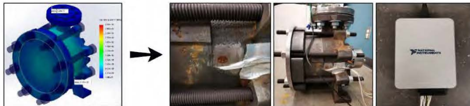
Figure 85 : Essai préliminaire et insertion des jauges de déformation
