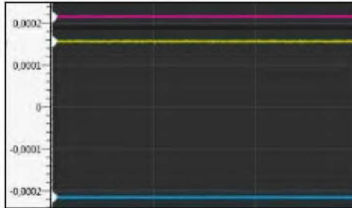
Figure 112 : État de déformation sous une pression de 1544.36 PSI
