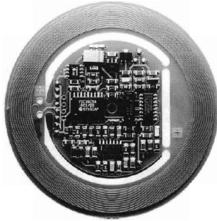
Figure 4 Lecteur d'un système RFID par coulage inductif à 135 kHz [1]
