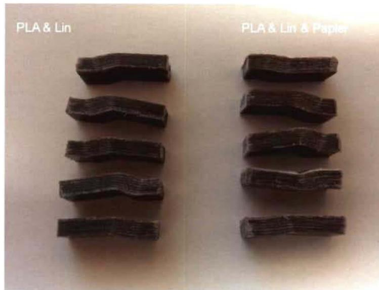
Figure 38: Éprouvettes courtes après essais de flexion
