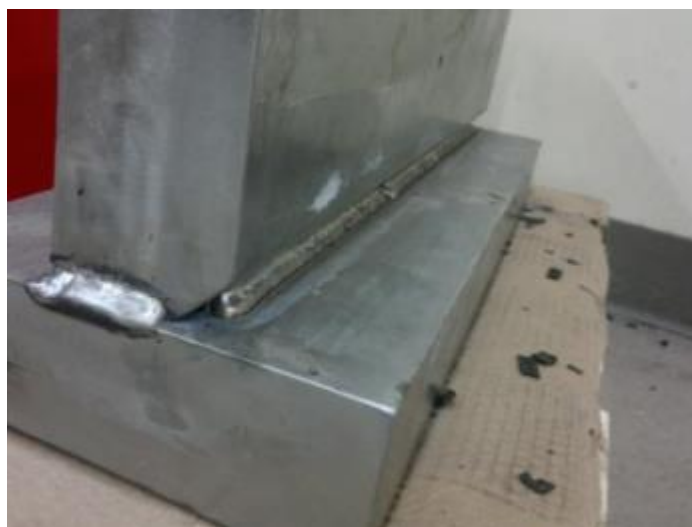
Figure 2.1 Montage pour acquisition des courbes de refroidissement en situation réelle
