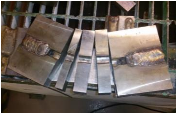
Figure 3.3 Position des coupes pour l'inspection des éprouvettes Tekken
