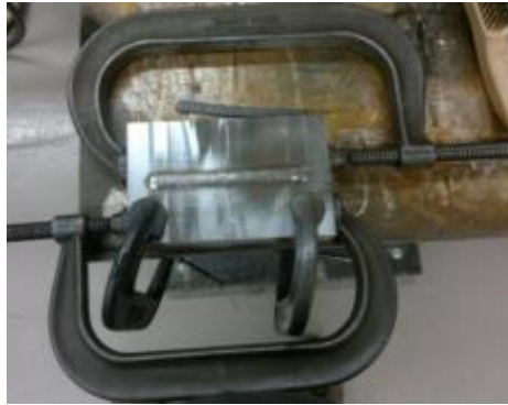
Figure 3.5 Montage pour essai préliminaire sur éprouvette GBOP
