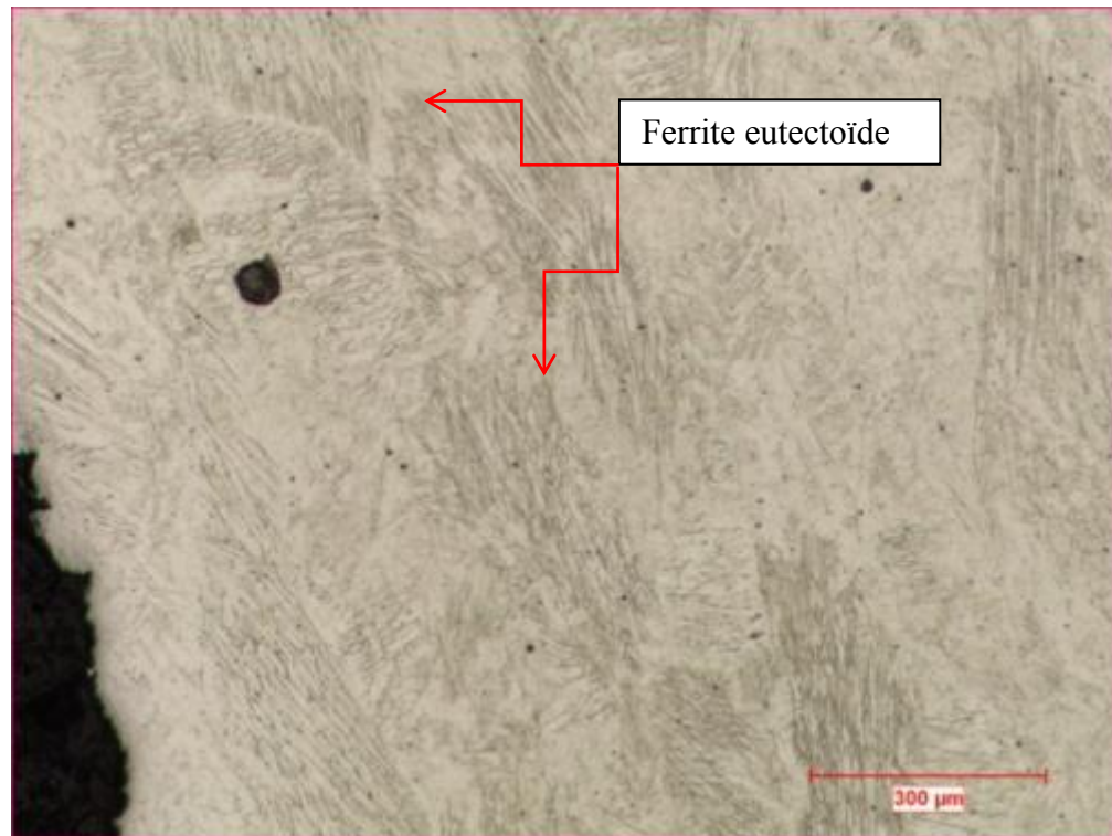
Figure 1.5 Ferrite eutectoïde (lignes foncées) située aux joints de grain dans la zone fondue d'un dépôt
