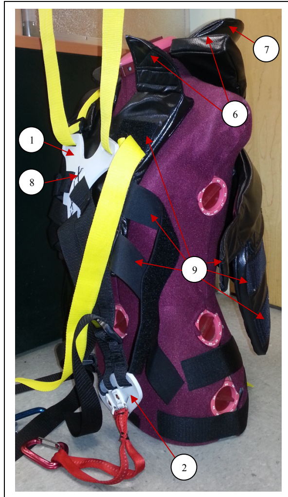
Figure 3.4 Ouvertures du tablier permettant l'installation du harnais
